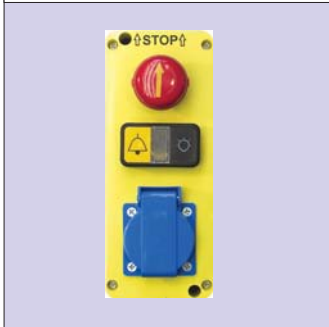
Grubensteuerstelle mit Notstop, Lichttaster, mit/ ohne Alarmtaster und Steckdose (EN81-80, Tabelle B2, 5.5.16)
